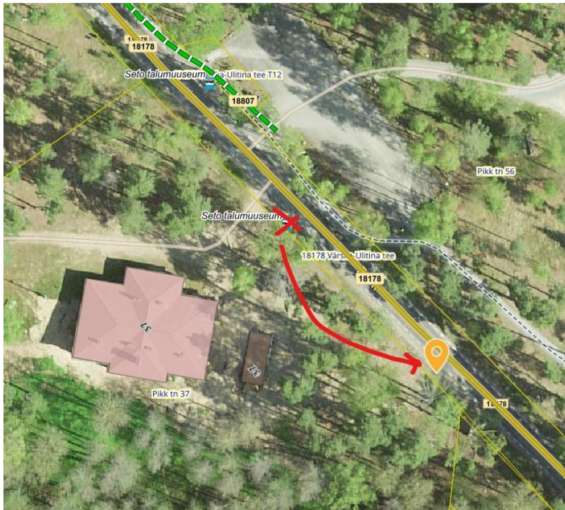
Joonis 1. Likvideeritav bussipeatus riigitee km 2,013 ja uue bussipeatuse asukoht riigitee km 2,06, väljavõte Maa- ja Ruumiameti geoportaalist
